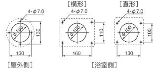
(2)外フランジを屋外側より貫通穴に差し込み、木ネジで固定します。
