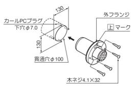
(3) 内フランジを浴室側から貫通穴に差し込み、外フランジと結合させ木ネジで固定します。 (排気接続口を下側にすること。)
