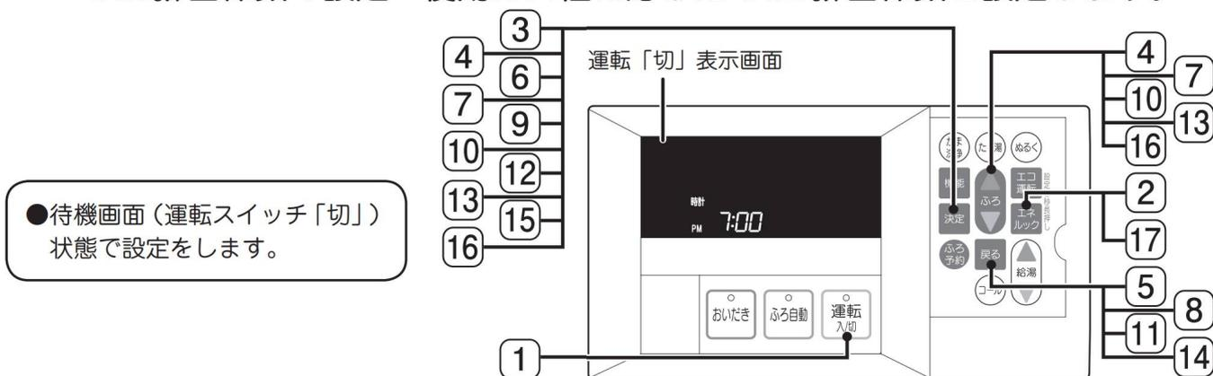
1 運転スイッチが「入」の場合、**運転入切** を押して、運転スイッチを「切」にする。
