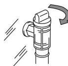
[ガス元栓の例]
