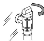
[ガス元栓の例]
