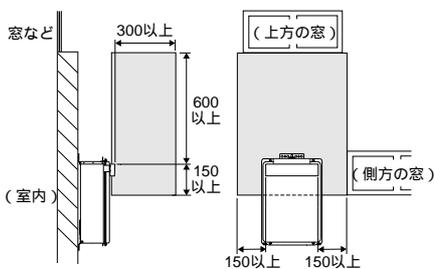
有効な遮へい物を設けた場合は左図のA + B寸法が600mm以上であれば建物開口禁止部の範囲でも可。
