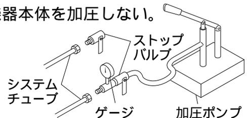
圧漏れが発見された場合、浴槽ボルトをいったん外し、浴槽穴あけ部のバリやゴミがないことを確認し、再試験を行ないます。
